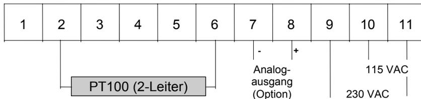
Versorgungsspannung 24 VDC -galv. getrennt-
