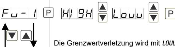
Die Grenzwertverletzung wird mit *LOW* (für *LOW* = unterer Grenzwert) und *HIGH* (für *HIGH* = oberer Grenzwert) ausgewählt. Abgeleitet von „lower limit“ = unterer Grenzwert und „higher limit“ = oberer Grenzwert. Ist z.B. Grenzwert 1 auf eine Schaltschwelle von 100 und mit Funktion *HIGH* belegt, wird bei Erreichen der Schaltschwelle der Alarm aktiviert. Ist der Grenzwert *LOW* zugeordnet wird bei Unterschreitung der Schaltschwelle ein Alarm ausgelöst, soweit die Hysterese Null ist.
