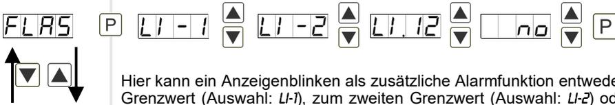
Hier kann ein Anzeigenblinken als zusätzliche Alarmfunktion entweder zum ersten Grenzwert (Auswahl: *L1-1*), zum zweiten Grenzwert (Auswahl: *L1-2*) oder zu beiden Grenzwerten (Auswahl: *L1-12*) hinzugefügt werden. Mit *NO* (Werkseinstellung) wird kein Blinken zugeordnet.
