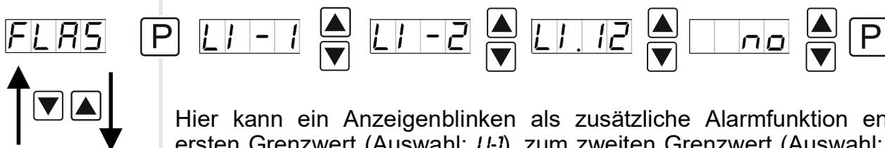
Hier kann ein Anzeigenblinken als zusätzliche Alarmfunktion entweder zum ersten Grenzwert (Auswahl: *LI-1*), zum zweiten Grenzwert (Auswahl: *LI-2*) oder zu beiden Grenzwerten (Auswahl: *LI-12*) hinzugefügt werden. Mit *NO* (Werkseinstellung) wird kein Blinken zugeordnet.
