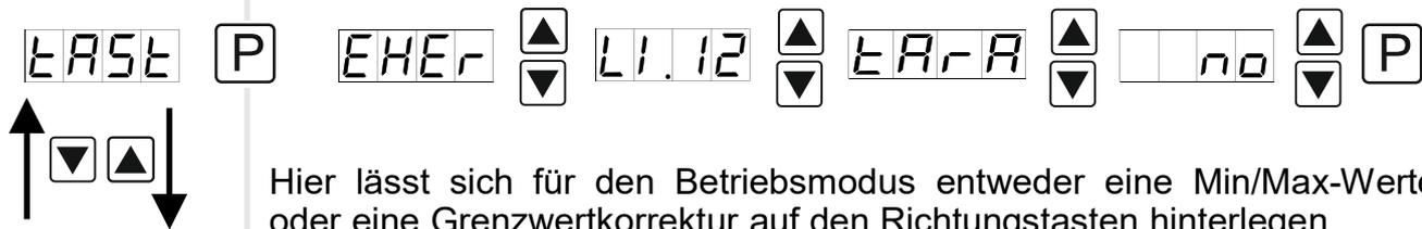
Hier lässt sich für den Betriebsmodus entweder eine Min/Max-Werteabfrage, oder eine Grenzwertkorrektur auf den Richtungstasten hinterlegen.
