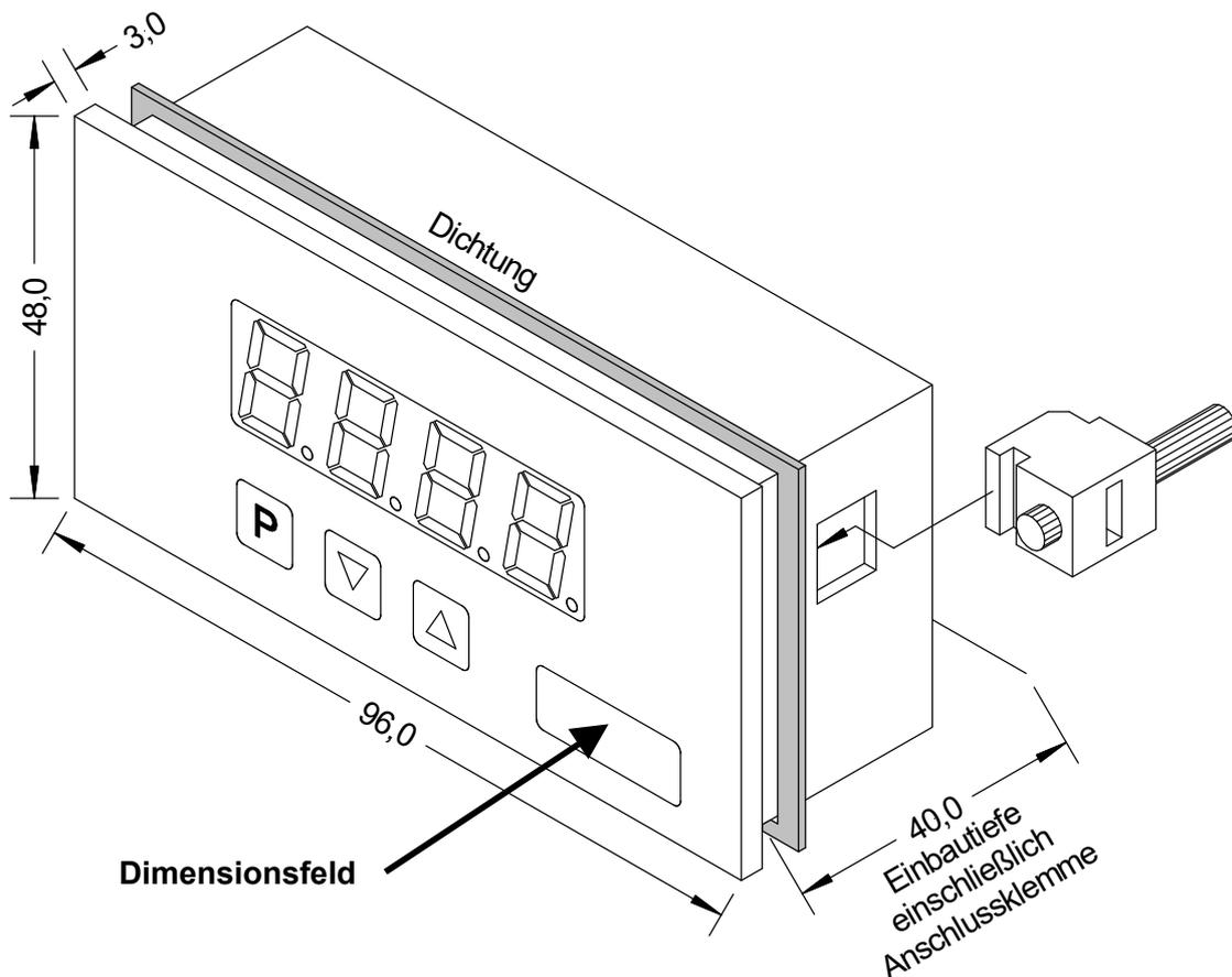
1. Nach Entfernen der Befestigungselemente das Gerät einsetzen.
