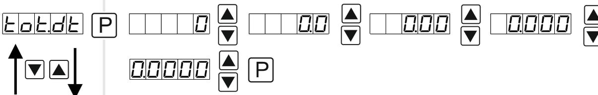
Die Dezimalstelle der Anzeige lässt sich mit **[▲]** **[▼]** anpassen. Mit **[P]** wird die Auswahl bestätigt und die Anzeige wechselt zurück in die Menü-Ebene.
