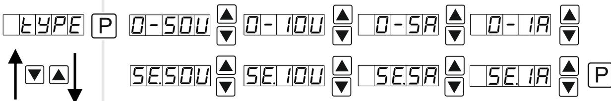
Als Messeingangsvarianten stehen 0-50 VAC / 0-10 VAC oder 0-5 AAC / 0-1 AAC Signale als Werkskalibration (ohne Anlegen des Sensorsignals) und *SE.50V*, *SE.10V*, *SE.5A* und *SE.1A* als Sensorkalibration (mit angelegtem Messsignal) zur Verfügung. Mit [▲] [▼] erfolgt die Auswahl und mit [P] wird diese bestätigt.
