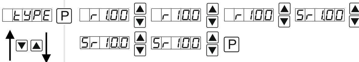
Als Messeingangsvarianten stehen Widerstandswerte von entweder 1, 10 oder 100 kΩ Signalen als Werkskalibration (ohne Anlegen des Sensorsignals) und als Sensorkalibration *SR.XXX* (mit angelegtem Messsignal) zur Verfügung. Mit **[P]** wird die Auswahl bestätigt und die Anzeige wechselt zurück zur Menü-Ebene.
