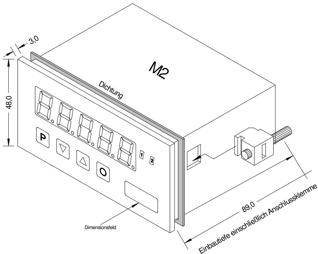
1. Nach Entfernen der Befestigungselemente das Gerät einsetzen.
