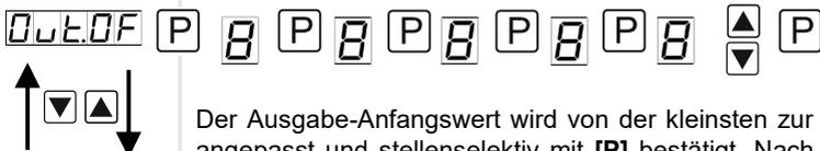
Der Ausgabe-Anfangswert wird von der kleinsten zur größten Stelle mit [▲] [▼] angepasst und stellenselektiv mit [P] bestätigt. Nach der letzten Stelle wechselt die Anzeige zurück in die Menü-Ebene. Der Wert entspricht je nach eingestelltem Ausgangssignal *OUT.RA* einer Spannung zwischen 0-10 V oder einem Strom 0-20 mA und wird erreicht, wenn als Sollwert der Einstell-Anfangswert *OFFS* erreicht wird.
