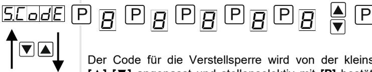
Der Code für die Verstellsperre wird von der kleinsten zur größten Stelle mit [▲] [▼] angepasst und stellenselektiv mit [P] bestätigt. Nach der letzten Stelle wechselt die Anzeige zurück in die Menü-Ebene. Ist der S.CODE auf einen Wert ungleich 0000 gestellt, wird die Codesperre für den TYPE F.TAST und F.INPU aktiviert. Das heißt bei jedem Einstellversuch wird der Freigabecode S.CODE abgefragt. Für TYPE-Einstellung E.TAST hat der Freigabecode S.CODE keine Bedeutung.
