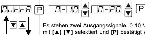
Es stehen zwei Ausgangssignale, 0-10 VDC und 0-20 mA zur Verfügung, welche mit [▲] [▼] selektiert und [P] bestätigt werden. Eine Eingrenzung des Ausgabebereiches lässt sich über *OUT.EN* und *OUT.OF* z.B. auf 4-20 mA begrenzen.
