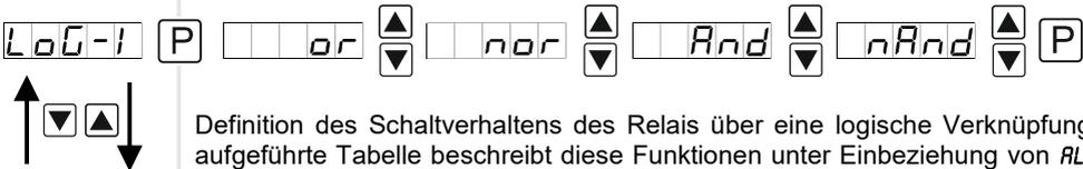
Definition des Schaltverhaltens des Relais über eine logische Verknüpfung. Die aufgeführte Tabelle beschreibt diese Funktionen unter Einbeziehung von *AL-1* und *AL-2*: Dieser Parameter ist nur erreichbar wenn *LOGIC* bei *REL-1* ausgewählt wurde.
