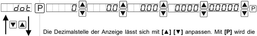
Die Dezimalstelle der Anzeige lässt sich mit [▲] [▼] anpassen. Mit [P] wird die Auswahl bestätigt und die Anzeige wechselt zurück in die Menü-Ebene. Die eingestellte Kommastelle hat keinen Einfluss auf die Schrittweite und wird ohne zusätzliche Abhängigkeiten in der Anzeige dargestellt.
