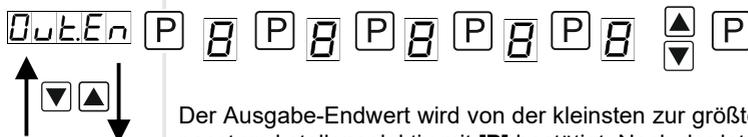
Der Ausgabe-Endwert wird von der kleinsten zur größten Stelle mit [▲] [▼] angepasst und stellenselektiv mit [P] bestätigt. Nach der letzten Stelle wechselt die Anzeige zurück in die Menü-Ebene. Der Wert entspricht je nach eingestelltem Ausgangssignal *OUT.RA* einer Spannung zwischen 0-10 V oder einem Strom 0-20 mA und wird erreicht, wenn als Sollwert der Einstell-Endwert *END* erreicht wird.
