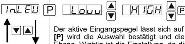
Der aktive Eingangspegel lässt sich auf LOW oder HIGH mit [▲] [▼] anpassen. Mit [P] wird die Auswahl bestätigt und die Anzeige wechselt zurück in die Menü-Ebene. Wichtig ist die Einstellung, da diese für alle Betriebsarten TYPE verwendet wird!
