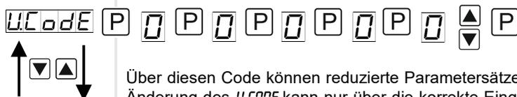
Über diesen Code können reduzierte Parametersätze freigeschaltet werden. Eine Änderung des *U.CODE* kann nur über die korrekte Eingabe des *R.CODE* (Mastercode) erfolgen.
