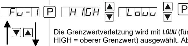
Die Grenzwertverletzung wird mit *LOW* (für *LOW* = unterer Grenzwert) und *HIGH* (für *HIGH* = oberer Grenzwert) ausgewählt. Abgeleitet von „lower limit“ = unterer Grenzwert und „higher limit“ = oberer Grenzwert. Ist z.B. Grenzwert 1 auf eine Schaltschwelle von 100 und mit Funktion *HIGH* belegt, wird bei Erreichen der Schaltschwelle der Alarm aktiviert. Ist der Grenzwert *LOW* zugeordnet wird bei Unterschreitung der Schaltschwelle ein Alarm ausgelöst, soweit die Hysterese Null ist.
