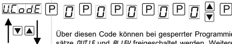
Über diesen Code können bei gesperrter Programmierung reduzierte Parametersätze *OUT.LE* und *ALL.EV* freigeschaltet werden. Weitere Parameter sind nicht über diesen Code erreichbar. Eine Änderung des *U.CODE* kann man nur über die korrekte Eingabe des *R.CODE* (Mastercode) erfolgen.
