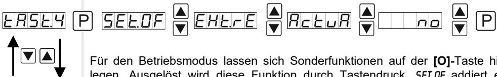
Für den Betriebsmodus lassen sich Sonderfunktionen auf der [O]-Taste hinterlegen. Ausgelöst wird diese Funktion durch Tastendruck. *SET.OF* addiert einen bestimmten Wert auf den aktuell angezeigten Wert im Display. *EHT.RE* löscht den Min/Max-Speicher. *ACTUA* zeigt den Messwert für ca. 7 Sekunden, danach springt die Anzeige auf den parametrisierten Anzeigewert. Ist *NO* angewählt ist die [O]-Taste im Betriebsmodus ohne Funktion.
