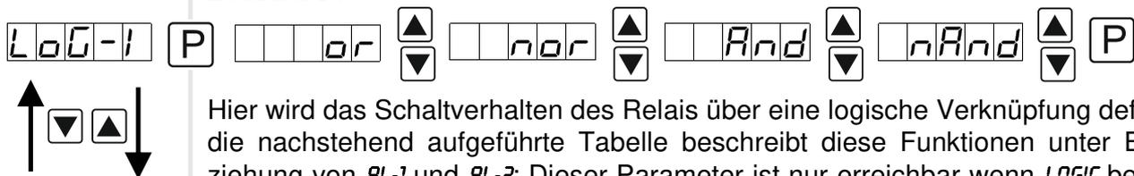
Hier wird das Schaltverhalten des Relais über eine logische Verknüpfung definiert, die nachstehend aufgeführte Tabelle beschreibt diese Funktionen unter Einbeziehung von *AL-1* und *AL-2*: Dieser Parameter ist nur erreichbar wenn *LOGIC* bei *REL-1* ausgewählt wurde.
