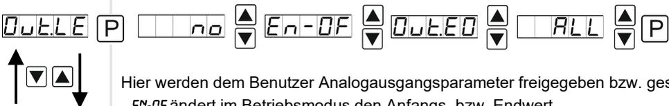
Hier werden dem Benutzer Analogausgangsparameter freigegeben bzw. gesperrt:
