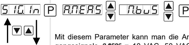
Mit diesem Parameter kann man die Anzeige entweder über die analogen Eingangssignale *R.MERS* = 10 VAC, 50 VAC bzw. 1,5 AAC oder über die digitalen Signale der Schnittstelle *N.BUS* = RS232/RS485 (Modbus-Protokoll) steuern. Mit **[P]** wird die Auswahl bestätigt und die Anzeige wechselt in die Menü-Ebene.
