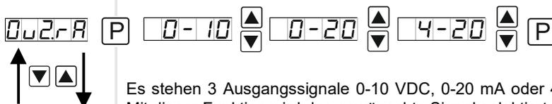
Es stehen 3 Ausgangssignale 0-10 VDC, 0-20 mA oder 4-20 mA zur Verfügung. Mit dieser Funktion wird das gewünschte Signal selektiert.
