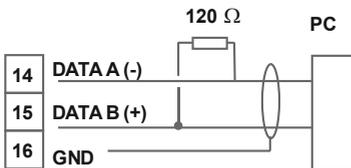
Die **RS485**-Schnittstelle wird über eine geschirmte Datenleitung mit verdrehten Adern (Twisted-Pair) angeschlossen. An jedem Ende des Bussegmentes muss eine Terminierung der Busleitungen angeschlossen werden. Diese ist erforderlich, um eine sichere Datenübertragung auf dem Bus zu gewährleisten. Hierzu wird ein Widerstand (120 Ohm) zwischen den Leitungen Data B (+) und Data A (-) eingefügt.
