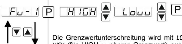
Die Grenzwertunterschreitung wird mit *LOW* (für LOW = unterer Grenzwert) und *HIGH* (für HIGH = oberer Grenzwert) ausgewählt. Abgeleitet von „lower limit“ = unterer Grenzwert und „higher limit“ = oberer Grenzwert. Ist z.B. Grenzwert 1 auf eine Schaltschwelle von 100 und mit Funktion *HIGH* belegt, wird bei Erreichen der Schaltschwelle der Alarm aktiviert. Ist der Grenzwert *LOW* zugeordnet wird bei Unterschreitung der Schaltschwelle ein Alarm ausgelöst, soweit die Hysterese Null ist.
