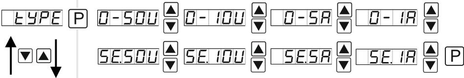
Als Messeingangsvarianten stehen 0-50 VAC/0-10 VAC oder 0-5 AAC/0-1 AAC Signale als Werkskalibration (ohne Anlegen des Sensorsignals) und *SE.50V*, *SE.10V*, *SE.5A* und *SE.1A* als Sensorkalibration (mit angelegtem Messsignal) zur Verfügung. Mit **[▲]** **[▼]** erfolgt die Auswahl und mit **[P]** wird diese bestätigt.
