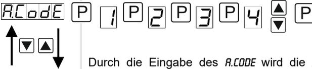
Durch die Eingabe des *R.CODE* wird die Anzeige entsperrt und alle Parameter freigeschaltet.
