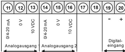
M3 mit Digitaleingang und externer Spannungsquelle
