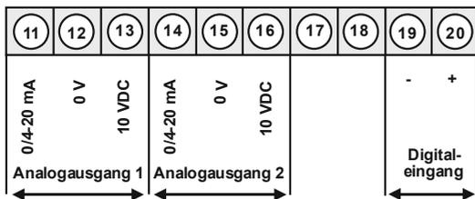
**M3 mit Digitaleingang und externer Spannungsquelle**
