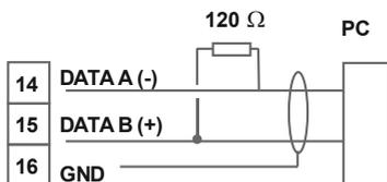
Die **RS485**-Schnittstelle wird über eine geschirmte Datenleitung mit verdrehten Adern (Twisted-Pair) angeschlossen. An jedem Ende des Bussegmentes muss eine Terminierung der Busleitungen angeschlossen werden. Diese ist erforderlich, um eine sichere Datenübertragung auf dem Bus zu gewährleisten. Dazu wird ein Widerstand (120 Ohm) zwischen den Leitungen Data B (+) und Data A (-) eingefügt.
