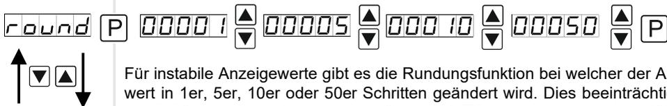
Für instabile Anzeigewerte gibt es die Rundungsfunktion bei welcher der Anzeigewert in 1er, 5er, 10er oder 50er Schritten geändert wird. Dies beeinträchtigt nicht die Auflösung der optionalen Ausgänge. Mit [P] wird die Auswahl bestätigt und man wechselt in die Menü-Ebene.
