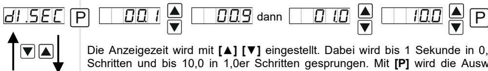
Die Anzeigezeit wird mit [▲] [▼] eingestellt. Dabei wird bis 1 Sekunde in 0,1er Schritten und bis 10,0 in 1,0er Schritten gesprungen. Mit [P] wird die Auswahl bestätigt und die Anzeige wechselt in die Menü-Ebene.
