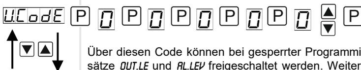
Über diesen Code können bei gesperrter Programmierung reduzierte Parametersätze *OUT.LE* und *AL.LEV* freigeschaltet werden. Weitere Parameter sind nicht über diesen Code erreichbar. Eine Änderung des *U.CODE* kann nur über die korrekte Eingabe des *R.CODE* (Mastercode) erfolgen.
