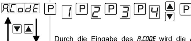
Durch die Eingabe des *R.CODE* wird die Anzeige entsperrt und alle Parameter freigeschaltet.
