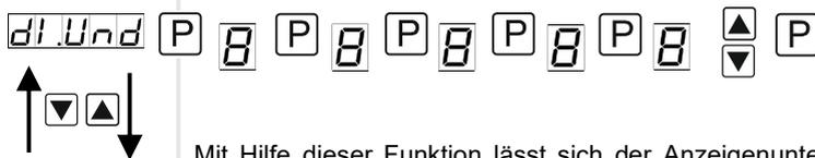
Mit Hilfe dieser Funktion lässt sich der Anzeigenunterlauf ( \_ \_ \_ \_ ) auf einen bestimmten Wert definieren.
