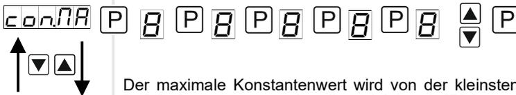
Der maximale Konstantenwert wird von der kleinsten bis zur größten Stelle mit [▲] [▼] angepasst und stellenselektiv mit [P] bestätigt. Ein Minuszeichen kann nur auf höchstwertigster Stelle parametrieren werden. Nach der letzten Stelle wechselt die Anzeige zurück in die Menü-Ebene.
