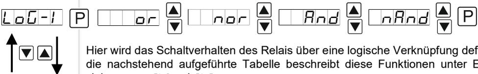
Hier wird das Schaltverhalten des Relais über eine logische Verknüpfung definiert, die nachstehend aufgeführte Tabelle beschreibt diese Funktionen unter Einbeziehung von *AL-1* und *AL-2*.
