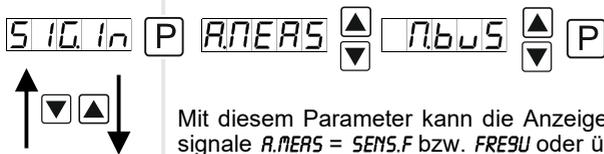
Mit diesem Parameter kann die Anzeige entweder über die analogen Eingangssignale *A.MEAS* = *SEMS.F* bzw. *FREQU* oder über die digitalen Signale der Schnittstelle *n.BUS* = RS232/RS485 (Modbus-Protokoll) gesteuert werden. Mit **[P]** wird die Auswahl bestätigt und die Anzeige wechselt in die Menü-Ebene.
