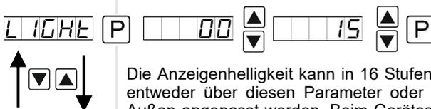
Die Anzeigehelligkeit kann in 16 Stufen von 00 = sehr dunkel bis 15 = sehr hell entweder über diesen Parameter oder alternativ über die Richtungstasten von Außen angepasst werden. Beim Gerätestart wird immer die in diesem Parameter hinterlegte Stufe verwendet, auch wenn zwischenzeitlich die Helligkeit über die Richtungstasten verändert wurde.
