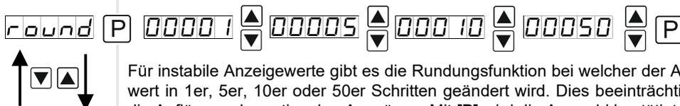
Für instabile Anzeigewerte gibt es die Rundungsfunktion bei welcher der Anzeigewert in 1er, 5er, 10er oder 50er Schritten geändert wird. Dies beeinträchtigt nicht die Auflösung der optionalen Ausgänge. Mit [P] wird die Auswahl bestätigt und die Anzeige wechselt in die Menü-Ebene.
