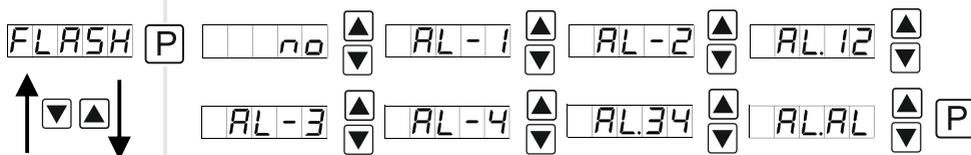
Hier kann ein Anzeigenblinken als zusätzliche Alarmfunktion entweder zu einzelnen oder zu einer Kombination von Grenzwertverletzungen hinzugefügt werden. Mit *NO* wird kein Blinken zugeordnet.
