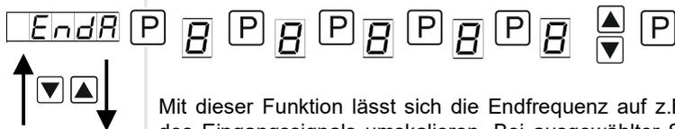
Mit dieser Funktion lässt sich die Endfrequenz auf z.B. 8.000 Hz ohne Anlegen des Eingangssignals umskalieren. Bei ausgewählter Sensorkalibration lässt sich dieser Parameter nicht überschreiben.
