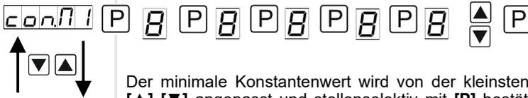
Der minimale Konstantenwert wird von der kleinsten bis zur größten Stelle mit [▲] [▼] angepasst und stellenselektiv mit [P] bestätigt. Ein Minuszeichen kann nur auf höchstwertigster Stelle parametrieren werden. Nach der letzten Stelle wechselt die Anzeige zurück in die Menü-Ebene.
