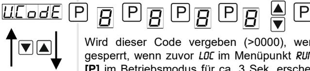
Wird dieser Code vergeben (>0000), werden dem Bediener alle Parameter gesperrt, wenn zuvor *LOC* im Menüpunkt *RUN* gewählt wurde. Durch Drücken von **[P]** im Betriebsmodus für ca. 3 Sek. erscheint in der Anzeige die Meldung *CODE*. Um nun zu den für den Benutzer frei geschalteten reduzierten Parametersatz zu gelangen, ist der hier vorgegebene *U.CODE* einzugeben. Der Code ist vor jedem Parametrierversuch einzugeben, bis der *R.CODE* (Mastercode) alle Parameter wieder freischaltet.
