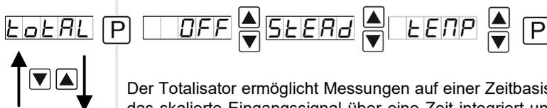
Der Totalisator ermöglicht Messungen auf einer Zeitbasis von z.B. l/h, hierbei wird das skalierte Eingangssignal über eine Zeit integriert und ständig (Anwahl *STEAD*) oder flüchtig (Anwahl *TEMP*) gespeichert. Wählt man *OFF* ist die Funktion deaktiviert. Mit **[P]** wird die Auswahl bestätigt und die Anzeige wechselt in die Menüebene.
