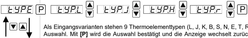
Als Eingangsvarianten stehen 9 Thermoelementtypen (L, J, K, B, S, N, E, T, R) zur Auswahl. Mit **[P]** wird die Auswahl bestätigt und die Anzeige wechselt zurück zur Menü-Ebene.
