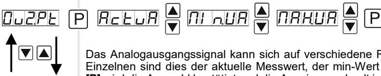
Das Analogausgangssignal kann sich auf verschiedene Funktionen beziehen, im Einzelnen sind dies der aktuelle Messwert, der min-Wert oder der max-Wert. Mit **[P]** wird die Auswahl bestätigt und die Anzeige wechselt in die Menü-Ebene.
