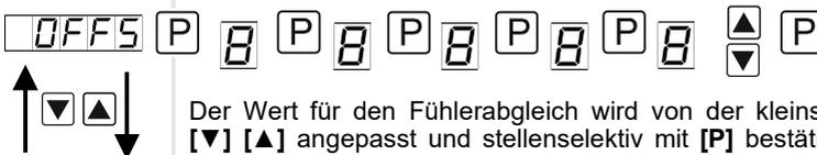
Der Wert für den Fühlerabgleich wird von der kleinsten zur größten Stelle mit **[▼]** **[▲]** angepasst und stellenselektiv mit **[P]** bestätigt. Nach der letzten Stelle wechselt die Anzeige zurück in die Menü-Ebene. Der Werteabgleich bei einer Temperaturmessung in °C kann zwischen -20,0 und +20,0 und bei einer Messung in °F zwischen -36,0 und +36,0 eingestellt werden. Wird die Art der Messung später umgeschaltet, wird der Wert gerundet.
