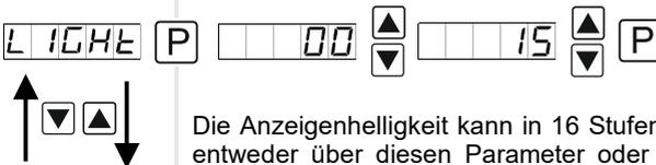
Die Anzeigehelligkeit kann in 16 Stufen von 00 = sehr dunkel bis 15 = sehr hell entweder über diesen Parameter oder alternativ über die Richtungstasten von außen angepasst werden. Beim Gerätestart wird immer die in diesem Parameter hinterlegte Stufe verwendet, auch wenn zwischenzeitlich die Helligkeit über die Richtungstasten verändert wurde.
