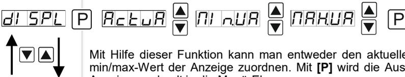
Mit Hilfe dieser Funktion kann man entweder den aktuellen Messwert oder den min/max-Wert der Anzeige zuordnen. Mit [P] wird die Auswahl bestätigt und die Anzeige wechselt in die Menü-Ebene.
