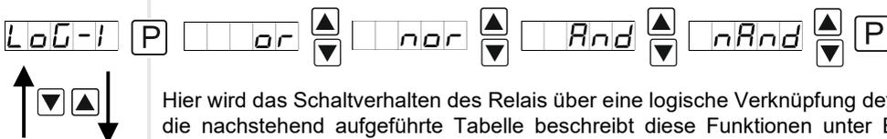
Hier wird das Schaltverhalten des Relais über eine logische Verknüpfung definiert, die nachstehend aufgeführte Tabelle beschreibt diese Funktionen unter Einbeziehung von *AL-1* und *AL-2*. Dieser Parameter ist nur erreichbar wenn bei *REL-1* *LOGIC* ausgewählt wurde.
