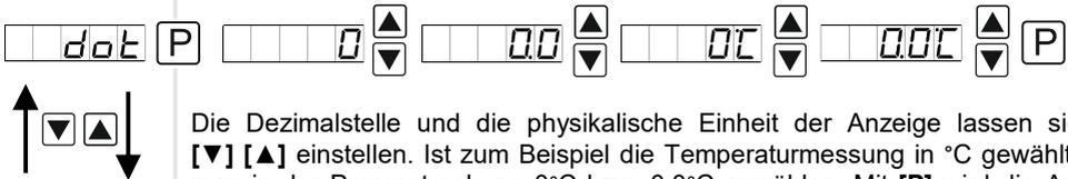
Die Dezimalstelle und die physikalische Einheit der Anzeige lassen sich mit **[▼]** **[▲]** einstellen. Ist zum Beispiel die Temperaturmessung in °C gewählt, kann man in der Parameterebene 0°C bzw. 0,0°C anwählen. Mit **[P]** wird die Auswahl bestätigt und die Anzeige wechselt zurück in die Menü-Ebene.
