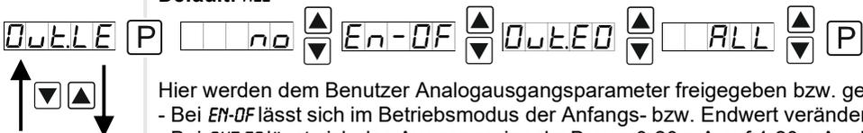
Hier werden dem Benutzer Analogausgangparameter freigegeben bzw. gesperrt:
