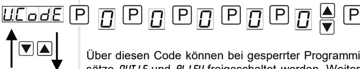
Über diesen Code können bei gesperrter Programmierung reduzierte Parametersätze *OUT.LE* und *AL.LEV* freigeschaltet werden. Weitere Parameter sind nicht über diesen Code erreichbar. Eine Änderung des *U.CODE* kann man nur über die korrekte Eingabe des *A.CODE* (Mastercode) erfolgen.
