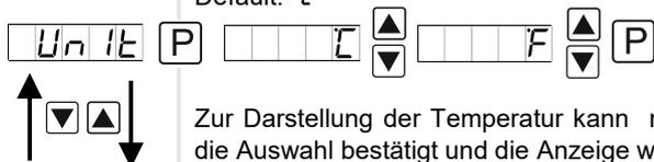
Zur Darstellung der Temperatur kann man unter °C und °F wählen. Mit [P] wird die Auswahl bestätigt und die Anzeige wechselt zurück zur Menü-Ebene.
