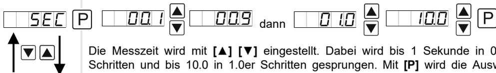
Die Messzeit wird mit [▲] [▼] eingestellt. Dabei wird bis 1 Sekunde in 0.1er Schritten und bis 10.0 in 1.0er Schritten gesprungen. Mit [P] wird die Auswahl bestätigt und die Anzeige wechselt in die Menü-Ebene.
