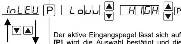
Der aktive Eingangspegel lässt sich auf *LOW* oder *HIGH* mit **[▲]** **[▼]** anpassen. Mit **[P]** wird die Auswahl bestätigt und die Anzeige wechselt zurück in die Menü-Ebene. Diese Einstellung ist wichtig, da sie für alle Betriebsarten *TYPE* verwendet wird!
