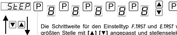
Die Schrittweite für den Einstelltyp *F.TAST* und *E.TAST* wird von der kleinsten zur größten Stelle mit [▲] [▼] angepasst und stellenselektiv mit [P] bestätigt. Nach der letzten Stelle wechselt die Anzeige zurück in die Menü-Ebene. Pro Tastendruck wird der Sollwert um die Schrittweite verändert, welche sich von 1...99999 wählen lässt.
