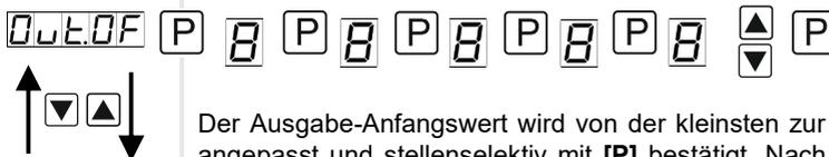
Der Ausgabe-Anfangswert wird von der kleinsten zur größten Stelle mit [▲] [▼] angepasst und stellenselektiv mit [P] bestätigt. Nach der letzten Stelle wechselt die Anzeige zurück in die Menü-Ebene. Der Wert entspricht je nach eingestelltem Ausgangssignal *OUT.RA* einer Spannung zwischen 0-10 V oder einem Strom 0-20 mA und wird erreicht, wenn als Sollwert der Einstell-Anfangswert *OFFS* erreicht wird.
