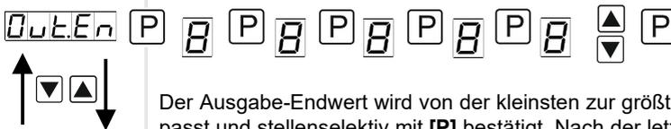
Der Ausgabe-Endwert wird von der kleinsten zur größten Stelle mit **[▲]** **[▼]** angepasst und stellenselektiv mit **[P]** bestätigt. Nach der letzten Stelle wechselt die Anzeige zurück in die Menü-Ebene. Der Wert entspricht je nach eingestelltem Ausgangssignal *OUT.RA* einer Spannung zwischen 0-10 V oder einem Strom 0-20 mA und wird erreicht, wenn als Sollwert der Einstell-Endwert *END* erreicht wird.
