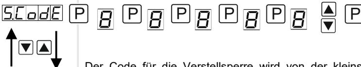
Der Code für die Verstellsperr wird von der kleinsten zur größten Stelle mit [▲] [▼] angepasst und stellenselektiv mit [P] bestätigt. Nach der letzten Stelle wechselt die Anzeige zurück in die Menü-Ebene. Ist der S.CODE auf einen Wert ungleich 0000 gestellt, wird die Codesperre für den TYPE F.TAST und F.IMPU aktiviert. Das heißt bei jedem Einstellversuch wird der Freigabecode S.CODE abgefragt. Für TYPE-Einstellung E.TAST hat der Freigabecode S.CODE keine Bedeutung.
