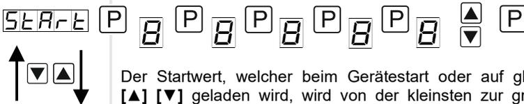
Der Startwert, welcher beim Gerätestart oder auf gleichzeitiges Drücken von [▲] [▼] geladen wird, wird von der kleinsten zur größten Stelle mit [▲] [▼] angepasst und stellenselektiv mit [P] bestätigt. Ein Minuszeichen kann nur auf der höchstwertigsten Stelle parametrieren. Nach der letzten Stelle wechselt die Anzeige zurück in die Menü-Ebene.
