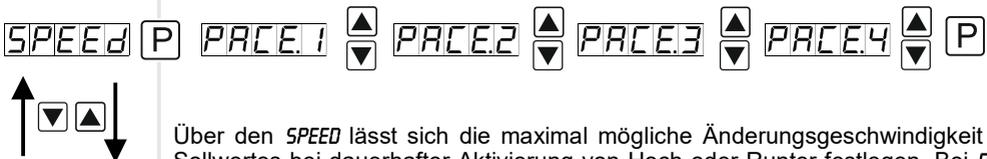
Über den *SPEED* lässt sich die maximal mögliche Änderungsgeschwindigkeit des Sollwertes bei dauerhafter Aktivierung von Hoch oder Runter festlegen. Bei *PACE.1* findet keine Vervielfachung der Schrittweite statt. Um jede weitere Pace-Stufe verzehnfacht sich die Maximalgeschwindigkeit bis *PACE.4* mit Faktor 1000. Die Änderungsgeschwindigkeit wird bei dauerhaft aktiviertem Hoch oder Runter stufenweise erhöht.
