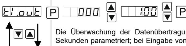
Die Überwachung der Datenübertragung wird in Sekunden bis maximal 100 Sekunden parametrier; bei Eingabe von 000 findet keine Überwachung statt. Das Timeout wird von der kleinsten bis zur größten Stelle mit [▲] [▼] angepasst und stellenselektiv mit [P] bestätigt. Nach der letzten Stelle wechselt die Anzeige in die Menü-Ebene.
