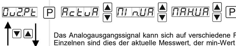
Das Analogausgangssignal kann sich auf verschiedene Funktionen beziehen, im Einzelnen sind dies der aktuelle Messwert, der min-Wert oder der max-Wert. Mit **[P]** wird die Auswahl bestätigt und die Anzeige wechselt in die Menü-Ebene.
