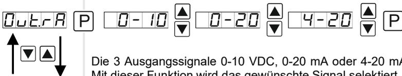
Die 3 Ausgangssignale 0-10 VDC, 0-20 mA oder 4-20 mA stehen zur Verfügung. Mit dieser Funktion wird das gewünschte Signal selektiert.
