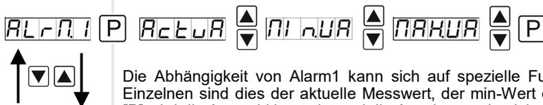
Die Abhängigkeit von Alarm1 kann sich auf spezielle Funktionen beziehen, im Einzelnen sind dies der aktuelle Messwert, der min-Wert oder der max-Wert. Mit [P] wird die Auswahl bestätigt und die Anzeige wechselt in die Menü-Ebene.
