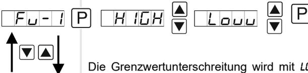
Die Grenzwertunterschreitung wird mit *LOW* (für LOW = unterer Grenzwert) und *HIGH* (für HIGH = oberer Grenzwert) ausgewählt. Abgeleitet von „lower limit“ = unterer Grenzwert und „higher limit“ = oberer Grenzwert. Ist z.B. Grenzwert 1 auf eine Schaltschwelle von 100 und mit Funktion *HIGH* belegt, wird bei Erreichen der Schaltschwelle der Alarm aktiviert. Ist der Grenzwert *LOW* zugeordnet wird bei Unterschreitung der Schaltschwelle ein Alarm ausgelöst, soweit die Hysterese Null ist.
