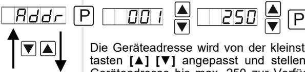
Die Geräteadresse wird von der kleinsten zur größten Stelle mit den Richtungstasten [▲] [▼] angepasst und stellenselektiv mit [P] bestätigt. Es steht eine Geräteadresse bis max. 250 zur Verfügung. Schnittstellendaten: Baudrate 9600 bit/s, 8 Databite, 1 Stopbit, keine Parität (8n1).
