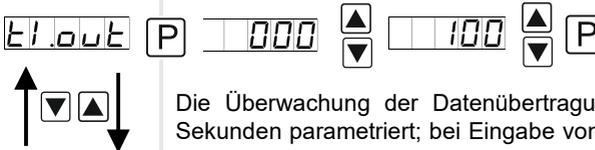
Die Überwachung der Datenübertragung wird in Sekunden bis maximal 100 Sekunden parametrisiert; bei Eingabe von 000 findet keine Überwachung statt. Das Timeout wird von der kleinsten bis zur größten Stelle mit [▲] [▼] angepasst und stellenselektiv mit [P] bestätigt. Nach der letzten Stelle wechselt die Anzeige in die Menü-Ebene.
