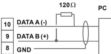
Die **RS485**-Schnittstelle wird über eine geschirmte Datenleitung mit verdrehten Adern (Twisted-Pair) angeschlossen. An jedem Ende des Bussegmentes muss eine Terminierung der Busleitungen angeschlossen werden. Diese ist erforderlich, um eine sichere Datenübertragung auf dem Bus zu gewährleisten. Hierzu wird ein Widerstand (120 Ohm) zwischen den Leitungen Data B (+) und Data A (-) eingefügt.
