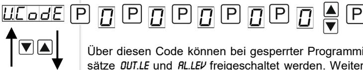
Über diesen Code können bei gesperrter Programmierung reduzierte Parametersätze *OUT.LE* und *AL.LEV* freigeschaltet werden. Weitere Parameter sind nicht über diesen Code erreichbar. Die Änderung des *U.CODE* kann nur über die korrekte Eingabe des *R.CODE* (Mastercode) erfolgen.
