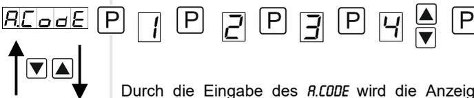
Durch die Eingabe des *R.CODE* wird die Anzeige entsperrt und alle Parameter freigeschaltet.
