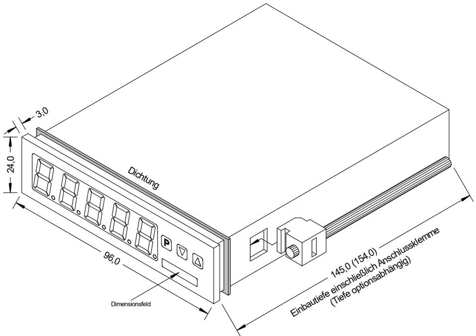
1. Nach Entfernen der Befestigungselemente das Gerät einsetzen.
