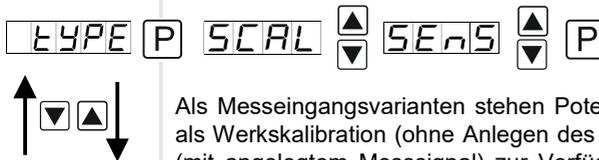
Als Messeingangsvarianten stehen Potentiometerwerte von  $>1\text{ k}\Omega$  bis  $<1000\text{ k}\Omega$  als Werkskalibration (ohne Anlegen des Sensorsignals) und als Sensorkalibration (mit angelegtem Messsignal) zur Verfügung. Mit **[P]** wird die Auswahl bestätigt und die Anzeige wechselt zurück zur Menü-Ebene.
