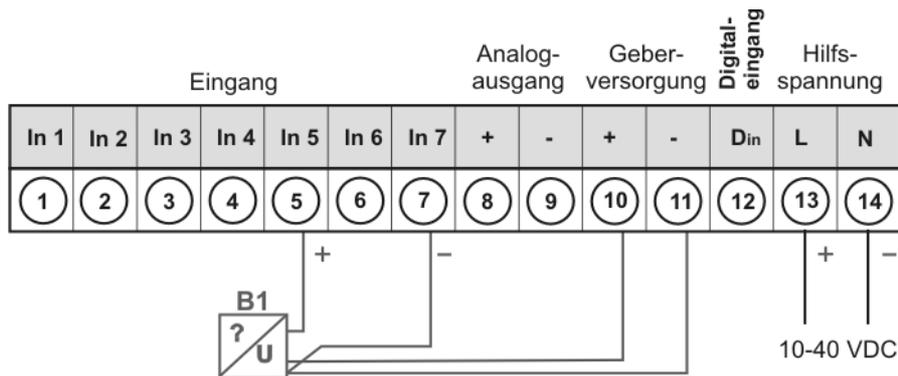
Messung eines **Spannungssignals** ( $\leq 2,5$  V) von einem **3-Leiter-Transmitter**, unter Verwendung der Geberversorgung; Hilfsspannung 100-240 VAC.
