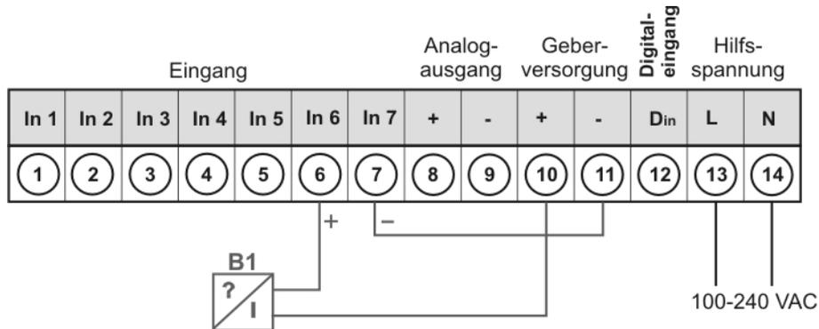
Messung eines **Spannungssignals** (5 V oder 10 V) von einem **3-Leiter-Transmitter**, unter Verwendung der Geberversorgung; Hilfsspannung 10-40 VDC.
