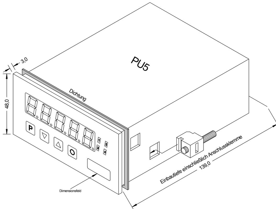
1. Nach Entfernen der Befestigungselemente das Gerät einsetzen.
